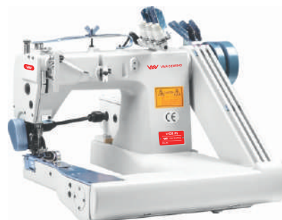
V-928-PS Трехигольная с пуллером японской конструкции
