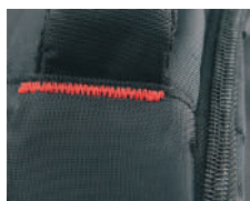
Тип BROTHER 430D для особо тяжелых материалов
