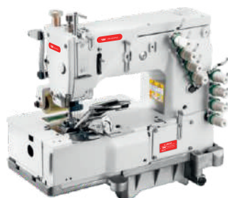
V-1404PSF 4-х игольная для шитья передка рубашки
